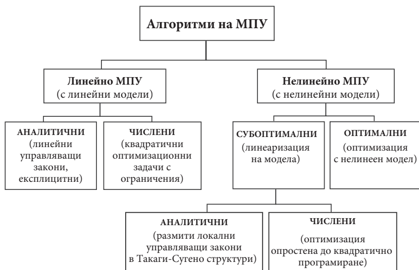
Фиг. 3 Основна класификация на моделно предсказващите алгоритми
